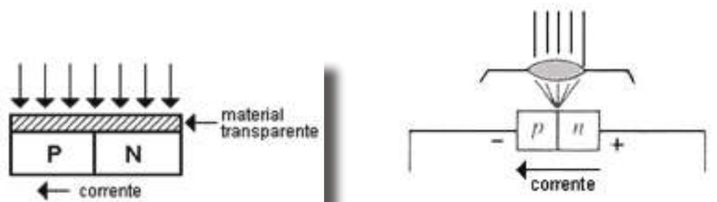
Para uma determinada tensão reversa ( $V_\lambda$ ) aplicada, a corrente ( $I_\lambda$ ) aumenta à medida que aumenta a intensidade luminosa.
